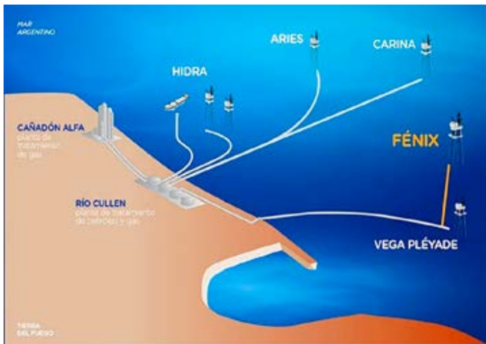
La producción de Fénix será transportada a través de un gasoducto que se conectará a la plataforma costa afuera Vega Pléyade. El gas será procesado y acondicionado en la planta de Río Cullen, y luego ingresará al Gasoducto San Martín.
